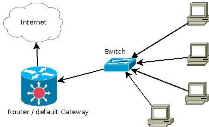
Hierfür wird ein Router / Gateway benötigt. Diese werden häufig als Schnittstelle zum Internet eingesetzt. Sie sind über eine WAN-Schnittstelle (ISDN / DSL / ...) mit dem Internet Provider verbunden. Nach dem Verbindungsaufbau wird der WAN-Schnittstelle des Routers in der Regel eine dynamische IP-Adresse aus dem Pool des Internet Service Providers zugewiesen.
